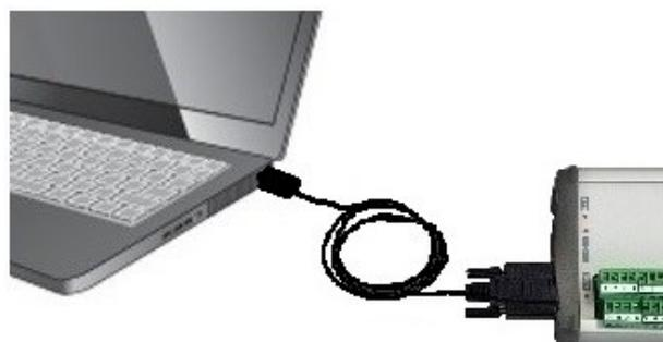
Al primo utilizzo è necessario inserire ALIEM nella lista degli strumenti di 3DOM e importare la configurazione di fabbrica dal data logger. Procedere come segue:
