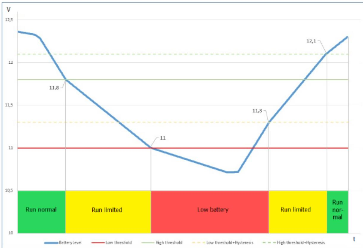
Fig. 7 – Stati di funzionamento di Alpha-Log.
