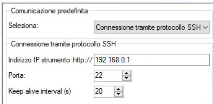
Fig. 20 – Esempio di connessione SSH ad Alpha-Log con indirizzo IP di fabbrica.
