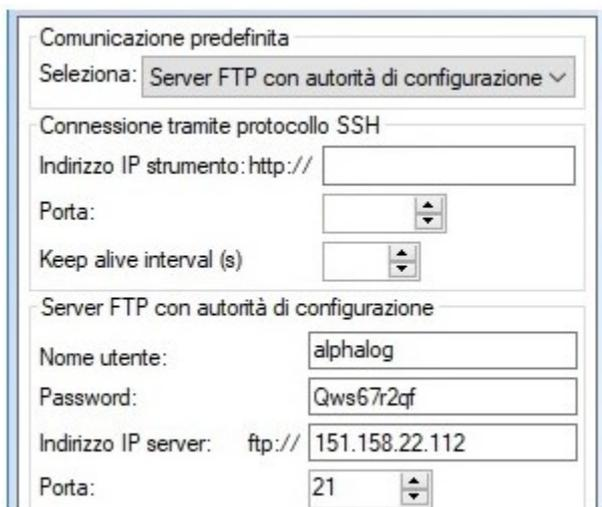
Fig. 22 – Esempio di connessione FTP.
