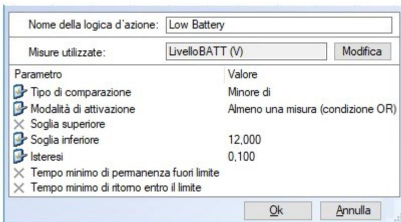
Fig. 16 – Esempio di logica di tipo *Comparazione di soglia*.
