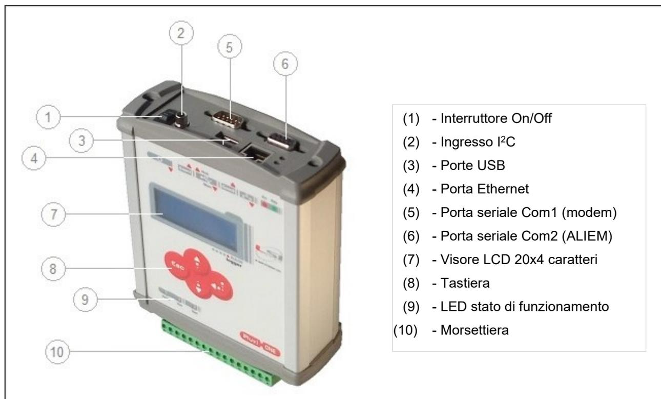
Fig. 1 – Descrizione strumento.
