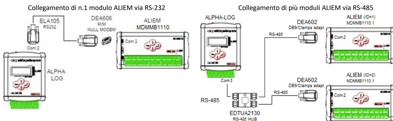
Alpha Log può gestire sul suo bus RS-485 contemporaneamente altri dispositivi Modbus RTU slave, come ad esempio sensori AIO.
